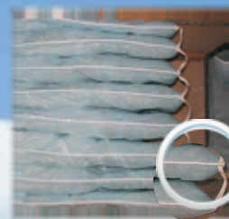
Рис. 2 Фото во время испытаний карманного фильтра с постоянным зазором между карманами
