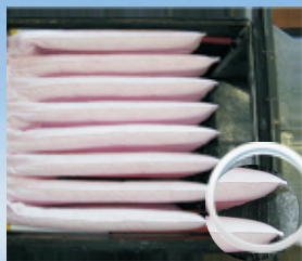
Рис. 1 Фото во время испытаний карманного фильтра с карманами клиновидной формы
