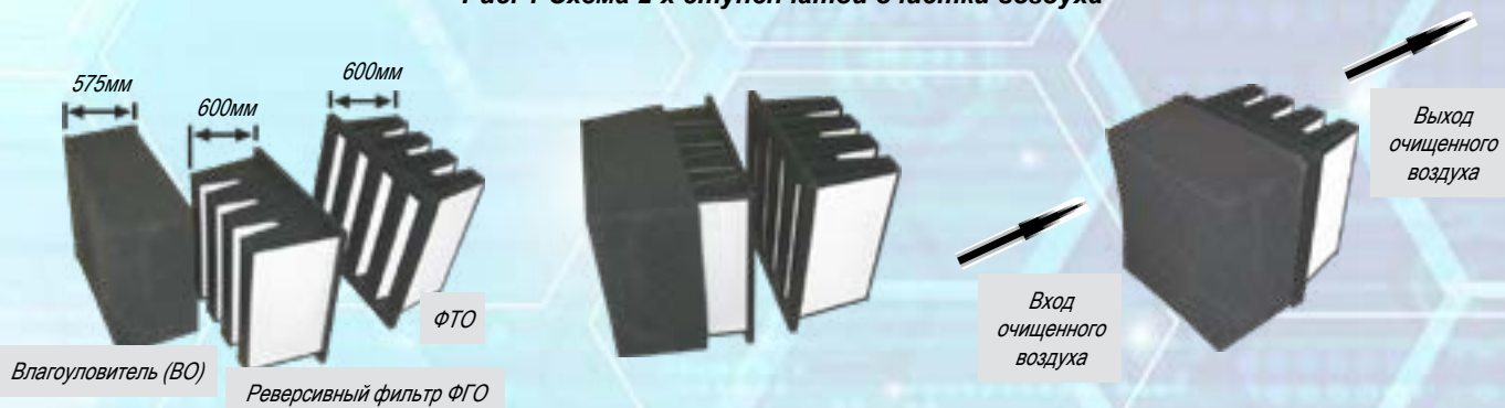
Рис.2 Схема 3-х ступенчатой очистки воздуха
