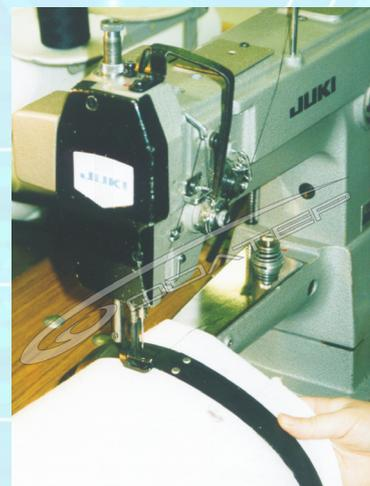
**Рис.3 Специализированная швейная машина фирмы «JUKI» для вшивания колец, пришивки буртиков и т.п.**
