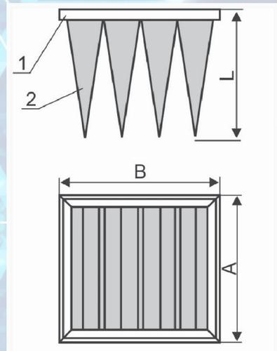
Рис.2. Схема фильтра ИФК
