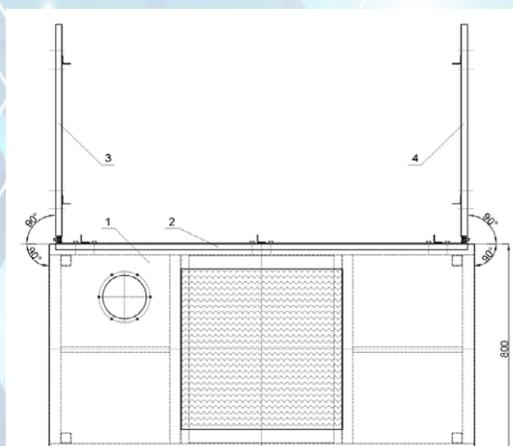
**Рис. 4 Схема раскрытия защитных панелей стола сварщика**
