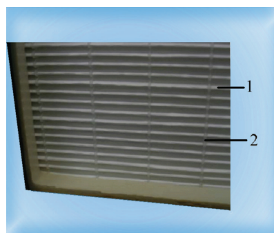
Рис. 2 Фрагмент фильтра с нитевыми сепараторами 1- фильтрующий материал; 2- платиновая нить;
