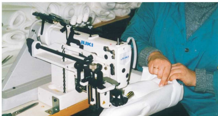
Рис.2 Специализированная швейная машина фирмы «JUKI», обеспечивающая шов «в замок»
