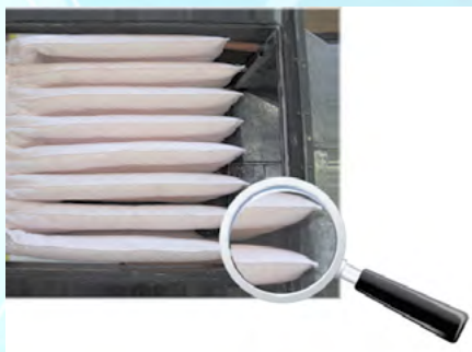
Рис.3 Фото во время испытаний карманного фильтра с карманами клиновидной формы
